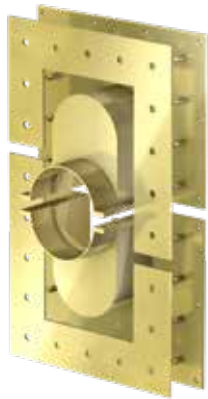
OBJECT // Afdichting voor muurdoorvoeringen van toevoerleidingen. Bijzondere eis: behoud van de aanwezige gebouwconstructie ondanks een uitgebreide sanering van de leidingen. Ontworpen en geproduceerd voor de sanering/verbouwing van een woongebouw op de monumentenlijst.
